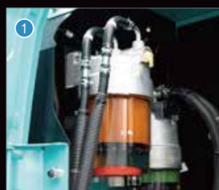
带油水分离功能的燃油预滤芯
