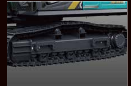
增强型履带校正器(单侧3个) 防止在恶劣的矿山现场的链轨脱落。
