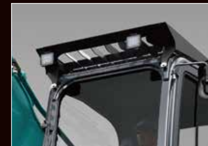
驾驶室顶部 2个LED照明灯 明亮的LED灯有助于提高夜间的可视性。
