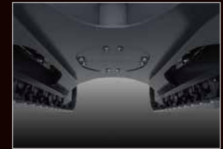
下车架底板加强/底部盖板 底板加强，提高下车架的强度。 标配底部盖板。
